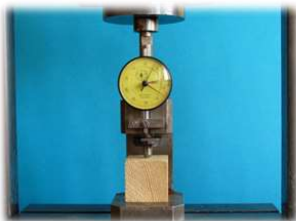
zatlačování ocelové kuličky daného průměru
