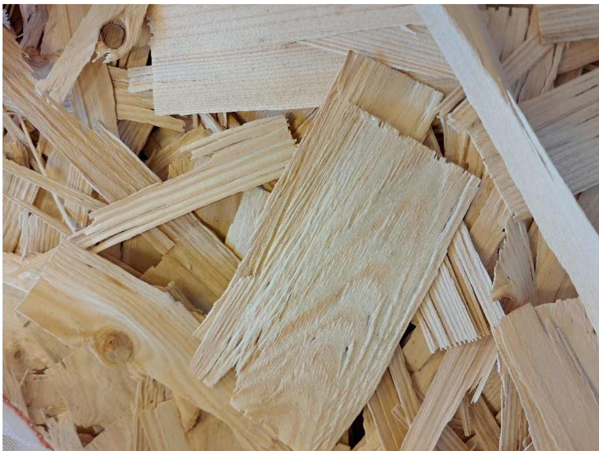
Obrázek 21 Ploché třísky z borovice, využívají se pro výrobu OSB zejména v Evropě
