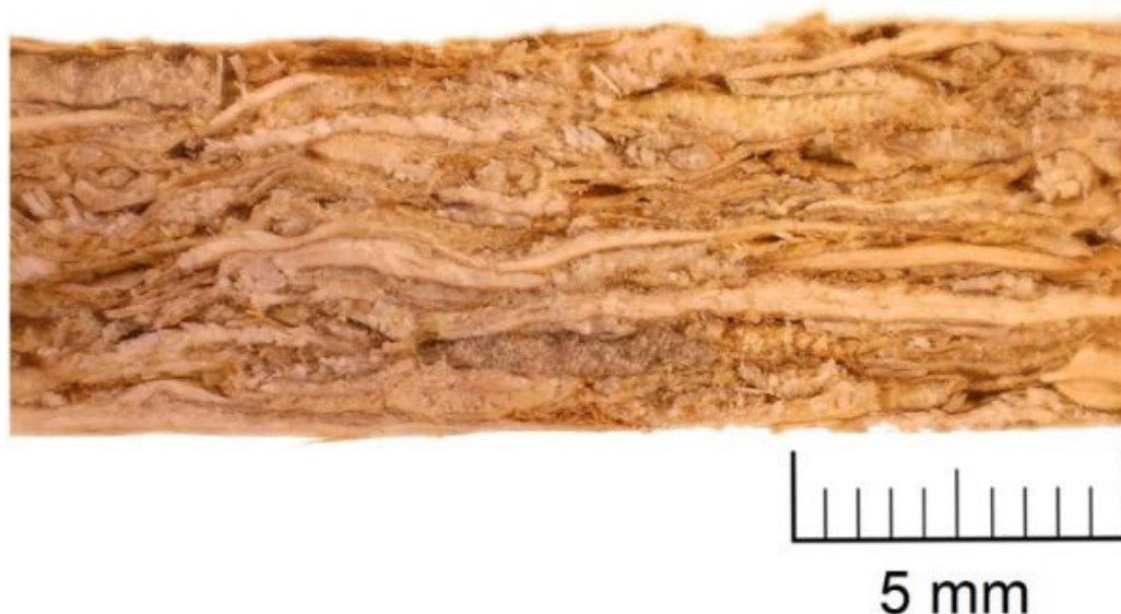
Obrázek 39 Řez třískovou deskou z pšeničné slámy
