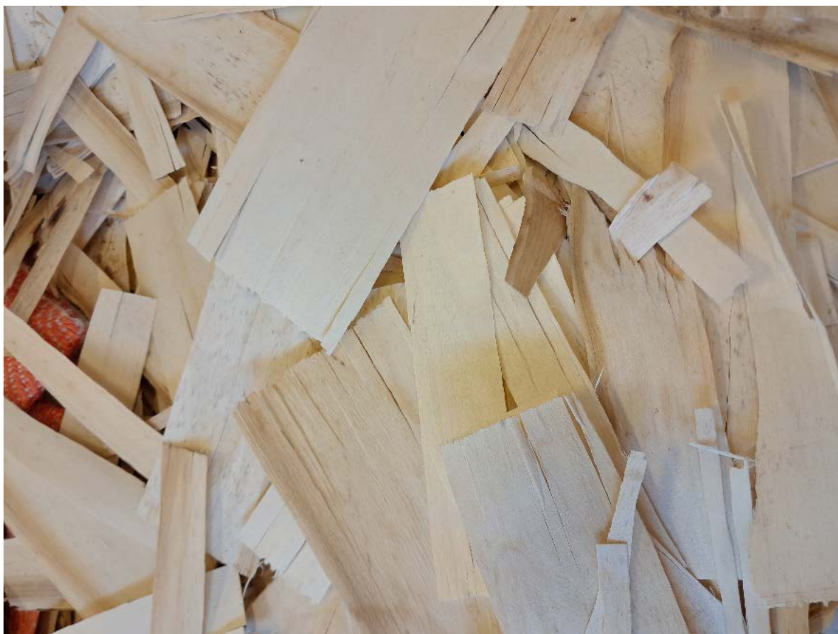
Obrázek 22 Ploché třísky z topolu, využívají se pro výrobu OSB zejména v USA
