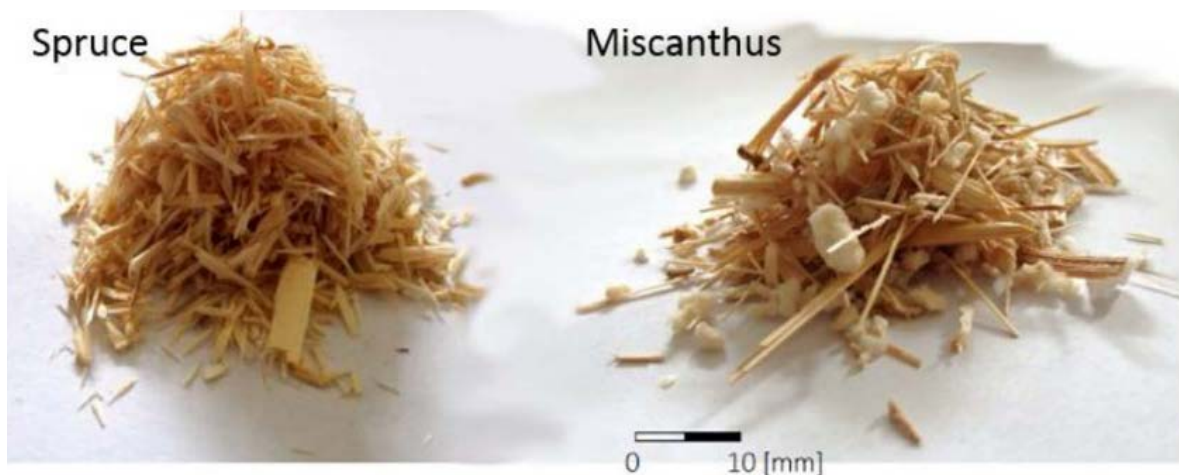
Obrázek 41 Porovnání třísek pro výrobu DTD ze smrku (vlevo) a z ozdobnice (vpravo)
