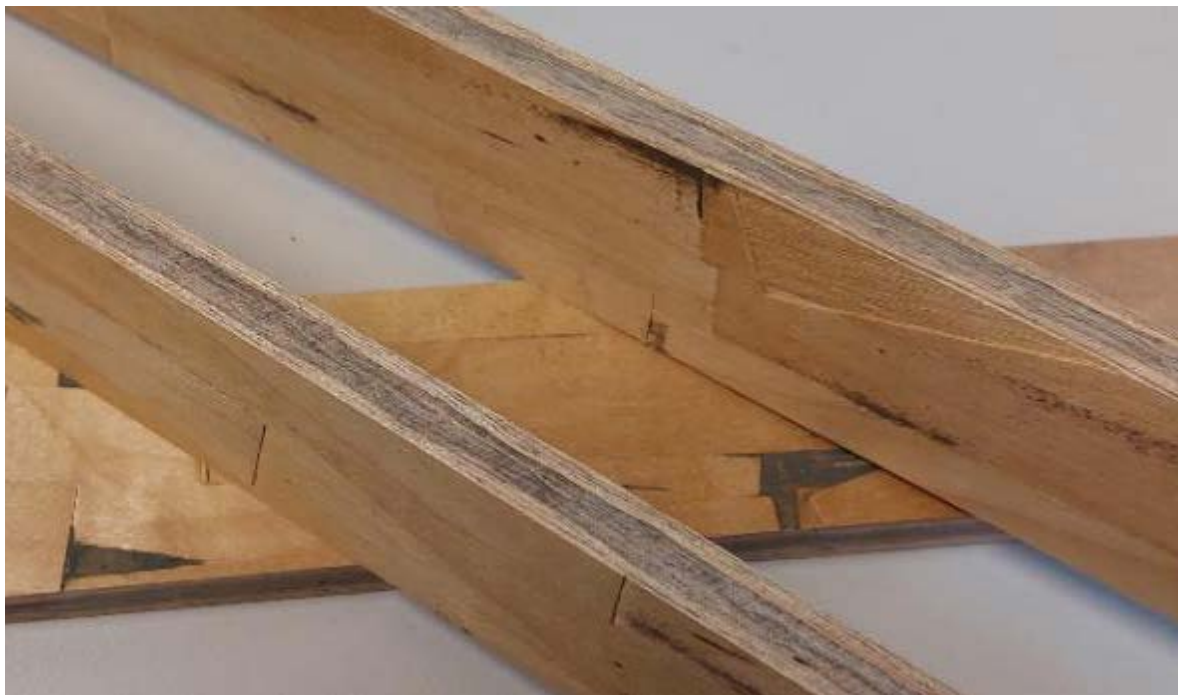
Obrázek 24 Pohled na řez laboratorně vyrobené OSB desky s patrnými povrchovými vrstvami a vrstvou středovou.
