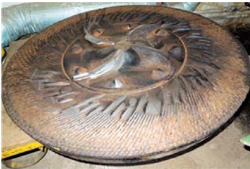
Obrázek 29 Příklad geometrie pracovní plochy refineru – použitý segment, výroba DDL
