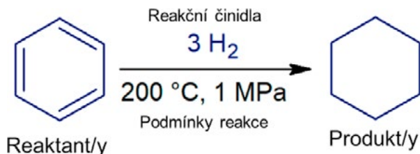
Obr. 43 Příklad zápisu reakce organických sloučenin - hydrogenace benzenu na cyklohexan
