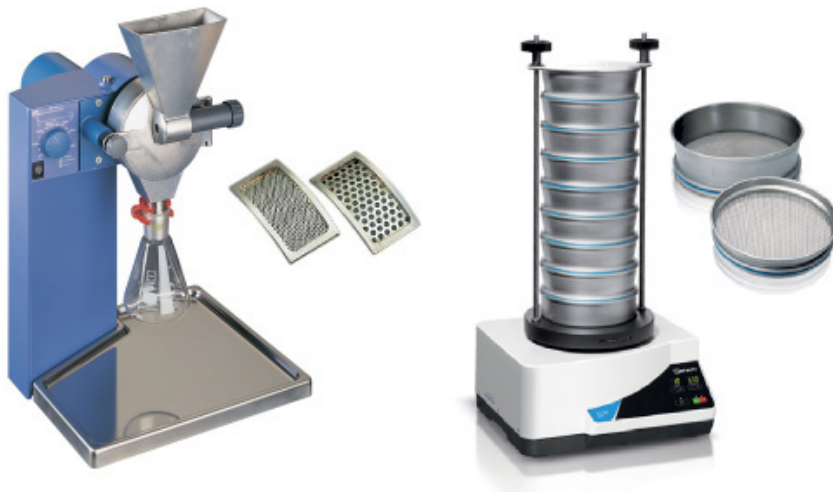
Obrázek 28 Laboratorní zařízení potřebná k úpravě vzorků dřeva pro chemické analýzy – nožový mlýn (vlevo), síťový třídící (vpravo)
