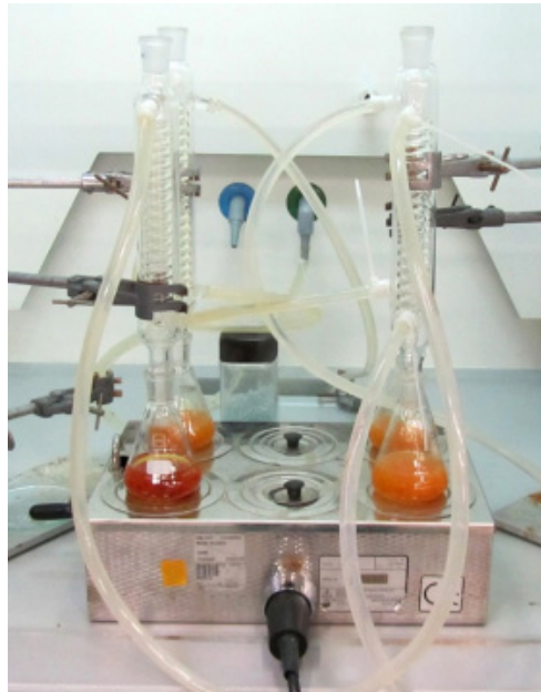
Obrázek 61 Aparatura pro ohřev vzorků se zpětným chlazením při izolaci celulózy
