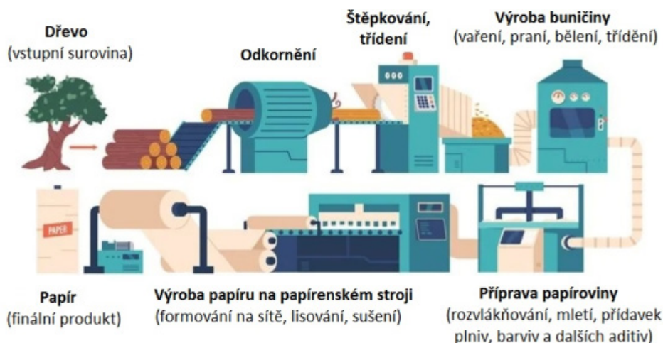
Obrázek 130 Zjednodušené schéma procesu výroby buničiny a papíru (www.azom.com)
