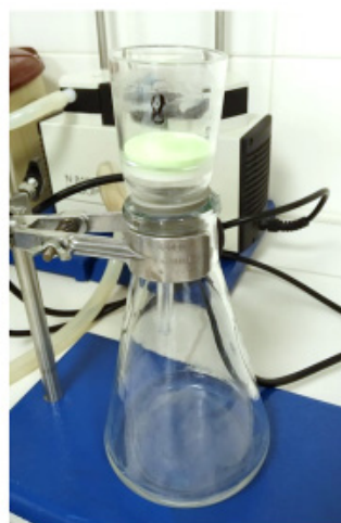
Obrázek 98 Laboratorní vybavení používané pro izolaci ligninu - varné baňky se zpětným chladičem v topném hnízdě (vlevo), odsávací baňka s fritou (vpravo)
