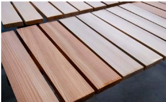
Obr. 3. 5 Zkušební vzorky pro test povětrnostním stárnutím (foto Oberhofnerová 2014)
