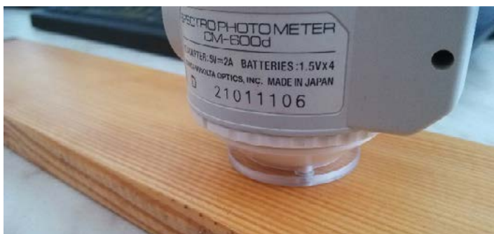
Obr. 3. 12 Měření barvy dřeva pomocí spektrofotometru (Oberhofnerová 2014)
