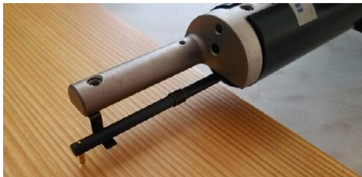
Obr. 3. 13 Měření drsnosti povrchu dřeva pomocí profilometru (Oberhofnerová 2014)
