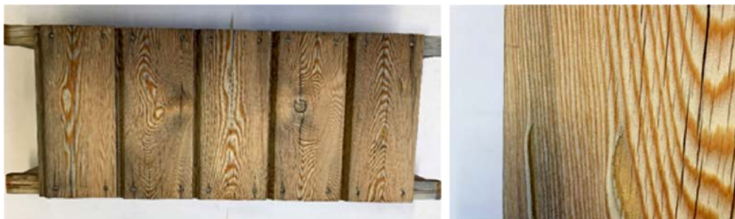
Obr. 1.23 Model fasády před testováním požární odolnosti po přirozeném stárnutí po dobu 2 let (Foto Štěrbová 2020)
