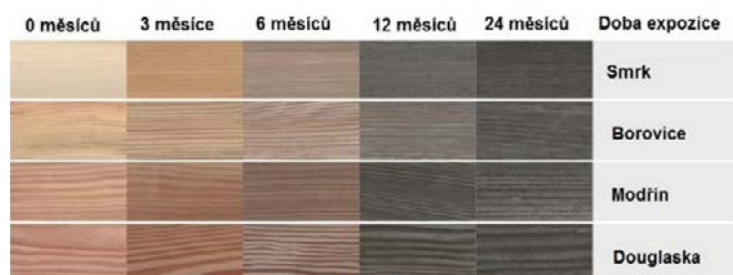
Obr. 5. 1 Změny povrchu dřeva v průběhu vnější expozice pod úhlem 45^\circ (Upraveno dle PÁNEK ET AL. 2021)
