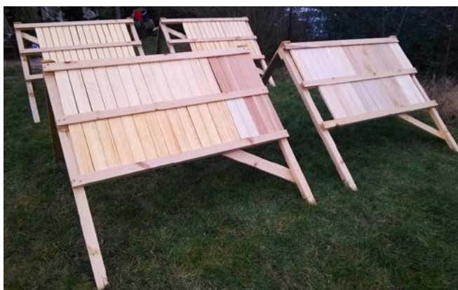
Obr. 3. 6 Zkouška povětrnostním stárnutím (foto Oberhofnerová 2014)
