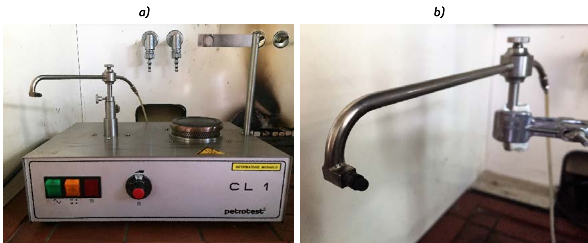
Obr. 3. 7 Laboratorní zařízení dle ČSN EN ISO 2592 (Clevelandova metoda) (foto Kadlicová 2017)
