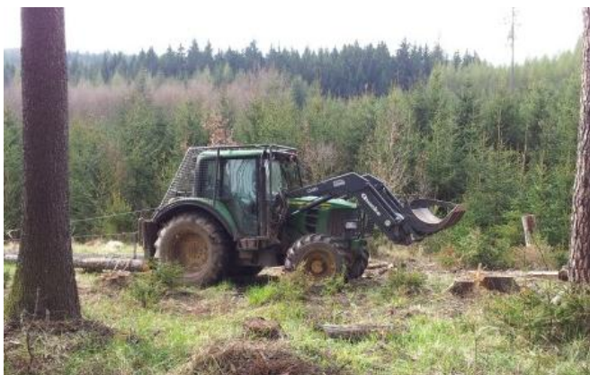
Obrázek 3 UKT (univerzální kolový traktor)
