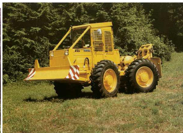
Obrázek 4 LKT (lesnický kolový traktor)
