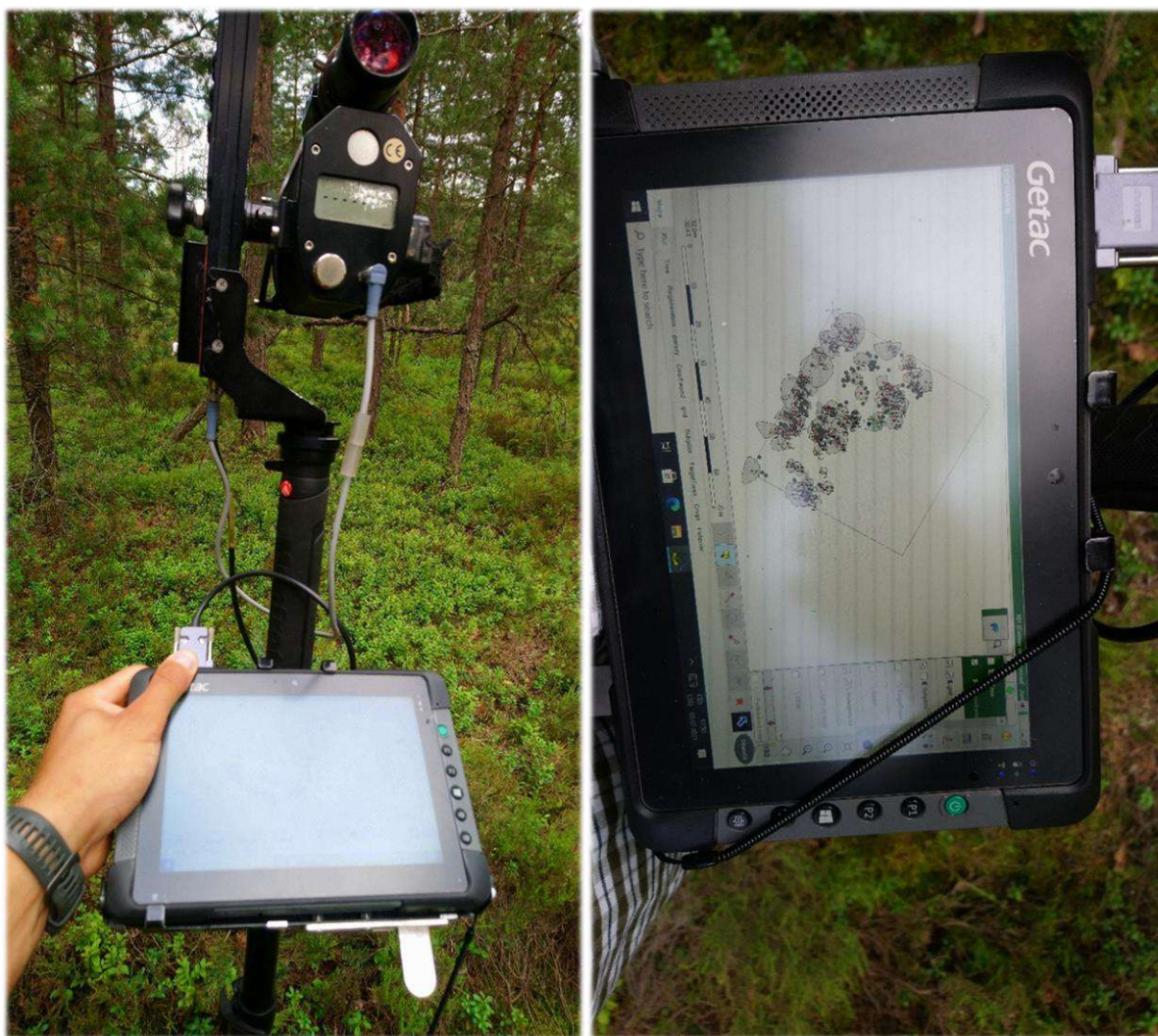
Obr. 9 Kompletní zařízení Field-Map (vlevo); Obr. 10 obrazovka tabletu s již zaznamenanými záměry jedinců borovice lesní (vpravo), Plasy 2020. Foto: Jakub Brichta
