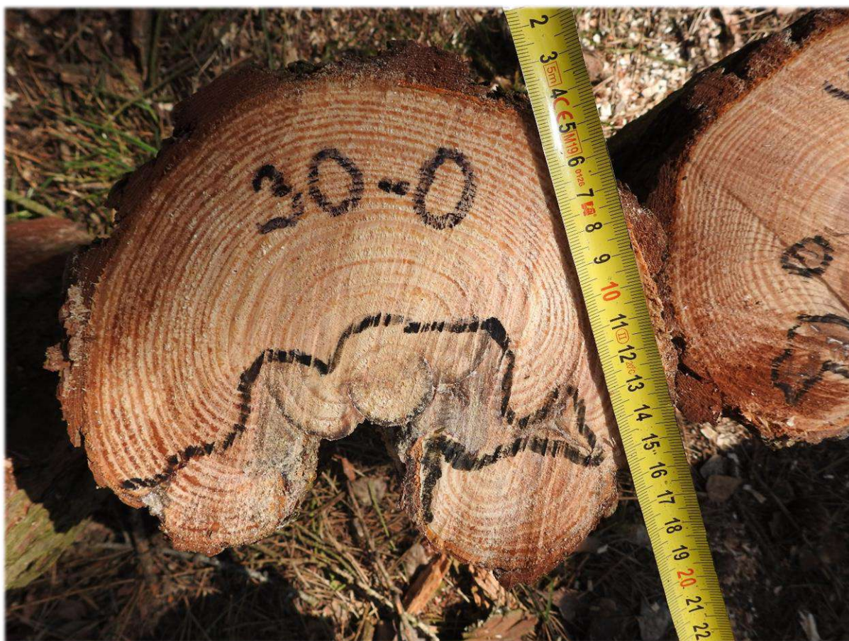
Obr. 11 Vzorník pro stanovení rozsahu hniloby, Úněšov 2021. Foto: Jakub Brichta
