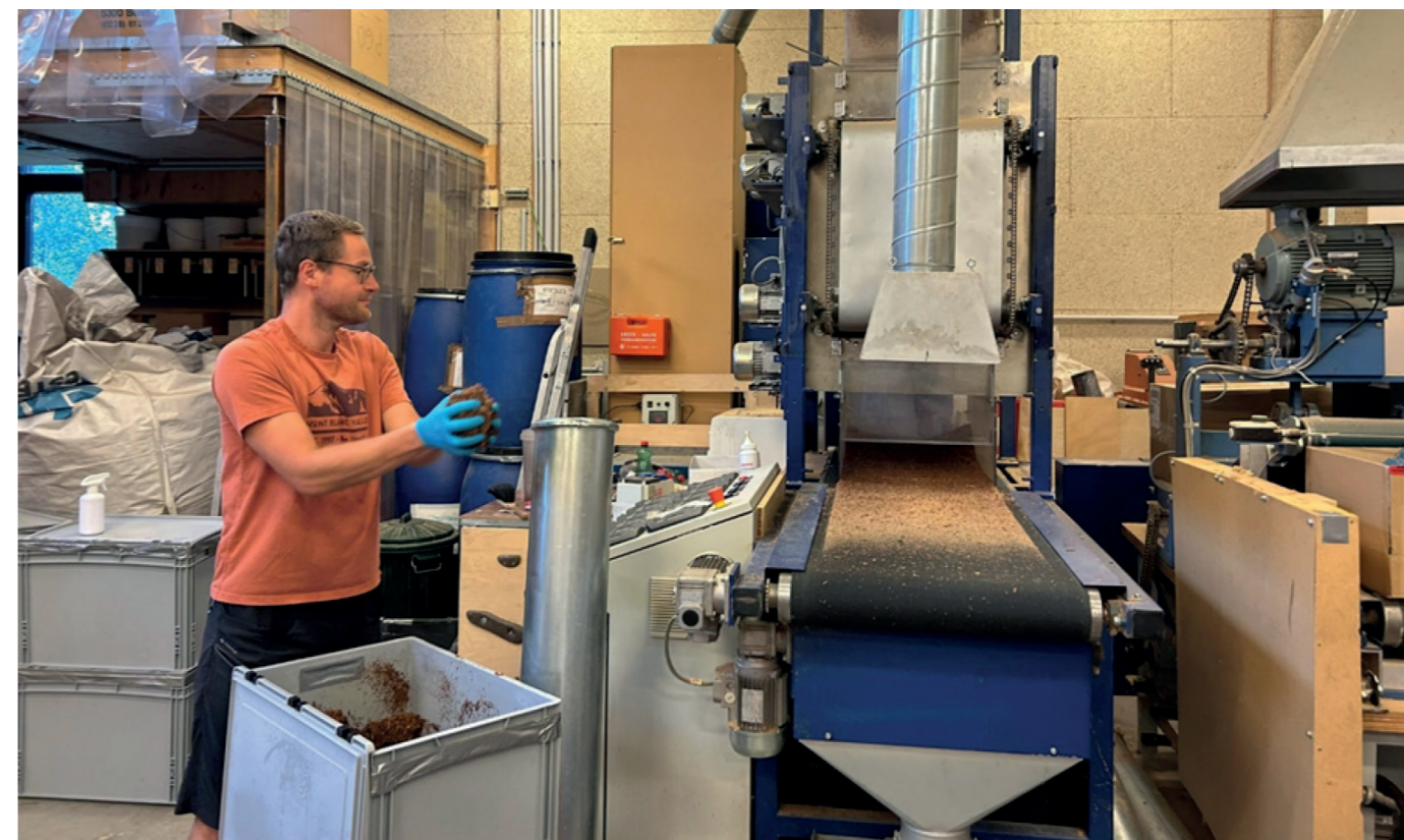
Kontinuální výroba tepelně izolačního panelu
