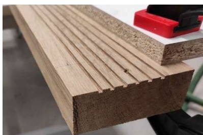
Obr. 43 Drážky pro vývod teplotních čidel
