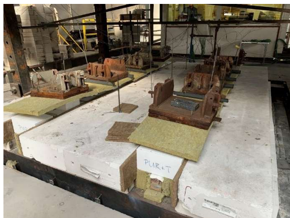
Obr. 62 Nosníky instalované ve velké horizontální peci
