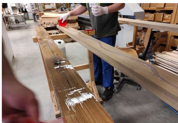
Obr. 49 Aplikace lepidla na lamely
