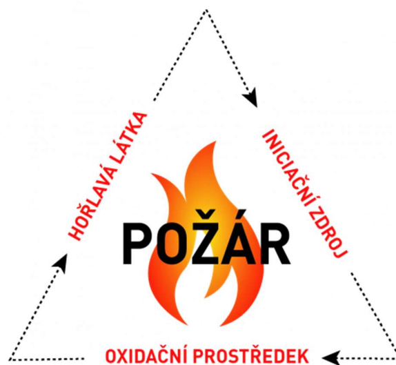
Obr. 23 Trojúhelník hoření (RSBP spol. s r.o., 2026)
