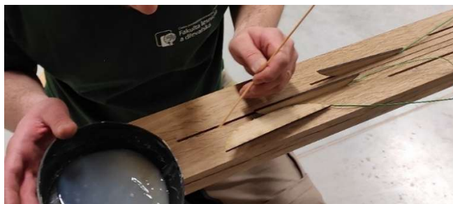
Obr. 47 Aplikace lepidla do vyhotovených drážek
