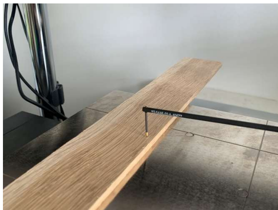
Obr. 29 Kontaktní metoda měření drsnosti
