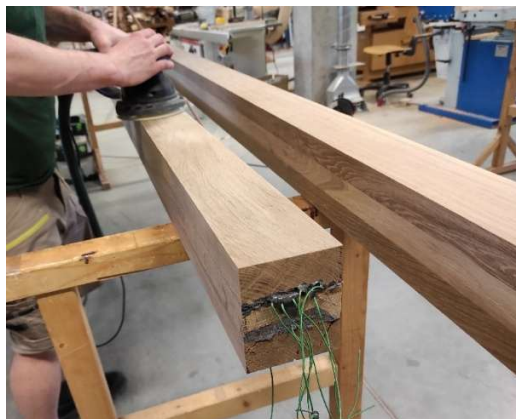
Obr. 59 Broušení nosníků - dokončování povrchu
