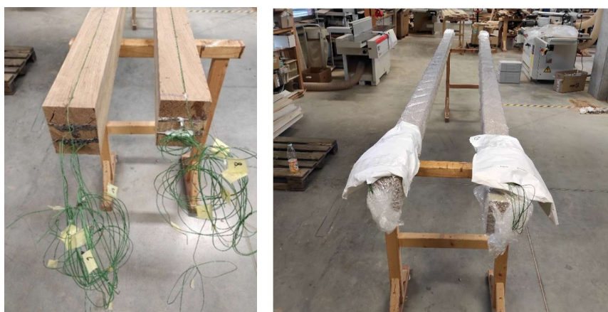
Obr. 60 Kontrola čidel a balení nosníků
