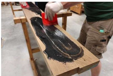
Obr. 55 Aplikace směsi lepidla a termosetické látky na lamely
