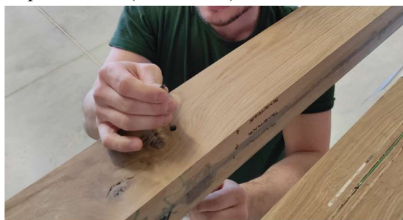
Obr. 56 Implementace lanka – průtahoměru
