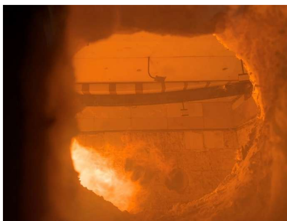
Obr. 64 Tepelná degradace zkušebních vzorků
