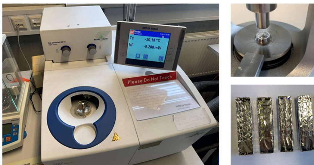
Obr. 28 Diferenční skenovací kalorimetr; lis na pánvičky s pokličkami; zkušební vzorky
