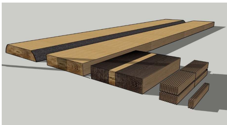
Obr. 30 Výroba zkušebních těles
