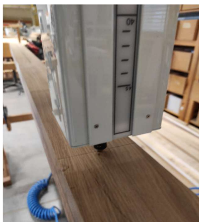
Obr. 51 Vrtání přístrojem Resistograf 4452-S
