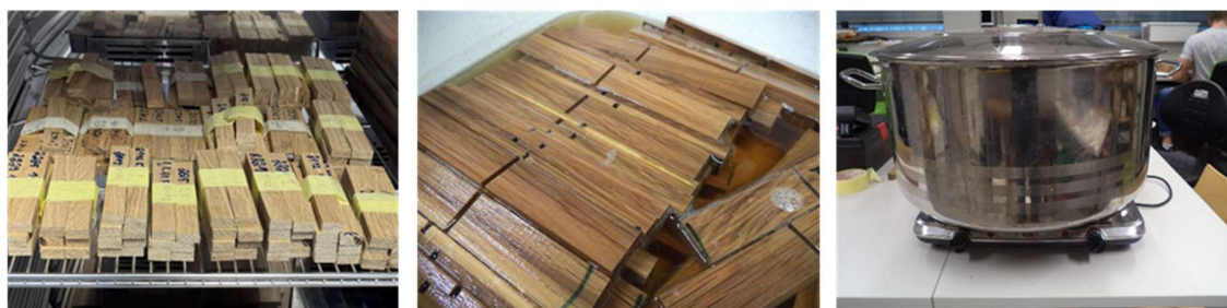
Obr. 31 Expozice těles jednotlivým fázím dle ČSN EN 302-1 (2023)
