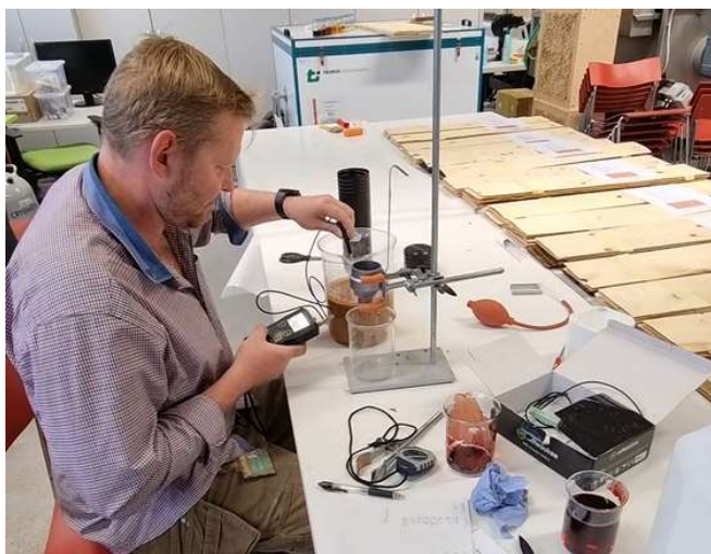
Obr. 7 Testování parametrů připraveného adheziva, konkrétně teploty a viskozity, pomocí Fordova kelímku.
