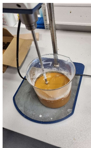
Obr. 6 Homogenizace lepicí směsi pomocí laboratorního míchadla s vrtulkovým nástavcem.
