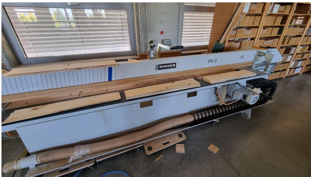
Obr. 3 Formátovací centrum, na kterém byly připravovány jednotlivé sestavy zkušebních těles.
