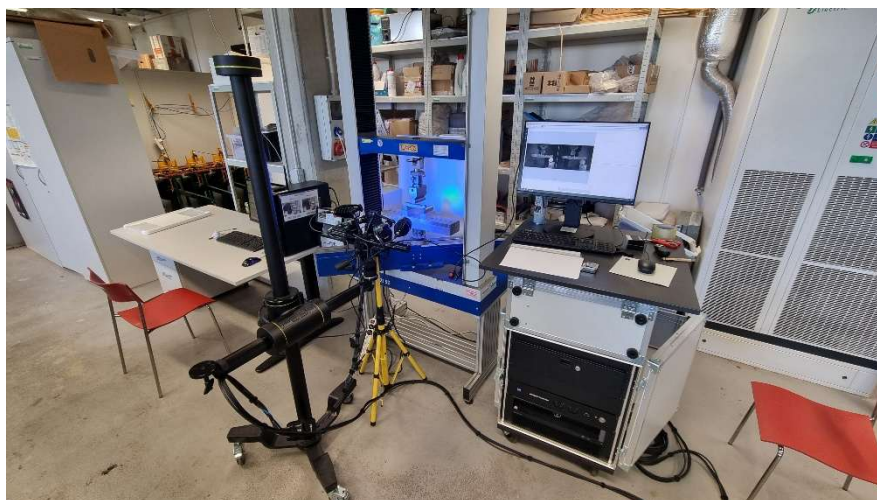
Obr. 22 Testovací sestava skládající se z TIRA Test 2850 a systému ARAMIS.
