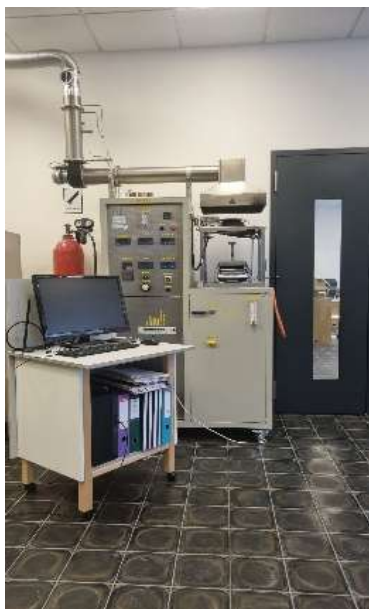
Obr. 19 Kónická kalorimetrie dle ISO 5660-1
