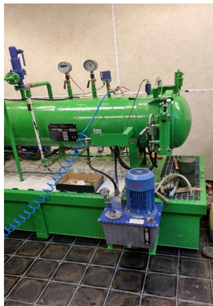
Obr. 4 Impregnační komora VYVOS s napojením na externí kompresor pro tlakový impregnační proces.
