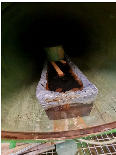
Obr. 5 Impregnační koryto s nalitým impregnačním roztokem, ve kterém jsou ponořené a zatížené dýhy během řízeného procesu penetrační impregnace.
