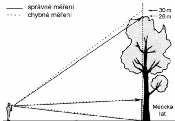
Obr.3: Trigonometrické měření výšek stromů
