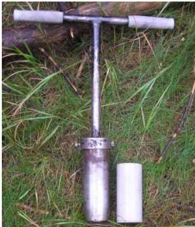
Obr. 4.2.1: Sonda k odběru kořenů, plastická vložka s odebraným vzorkem
